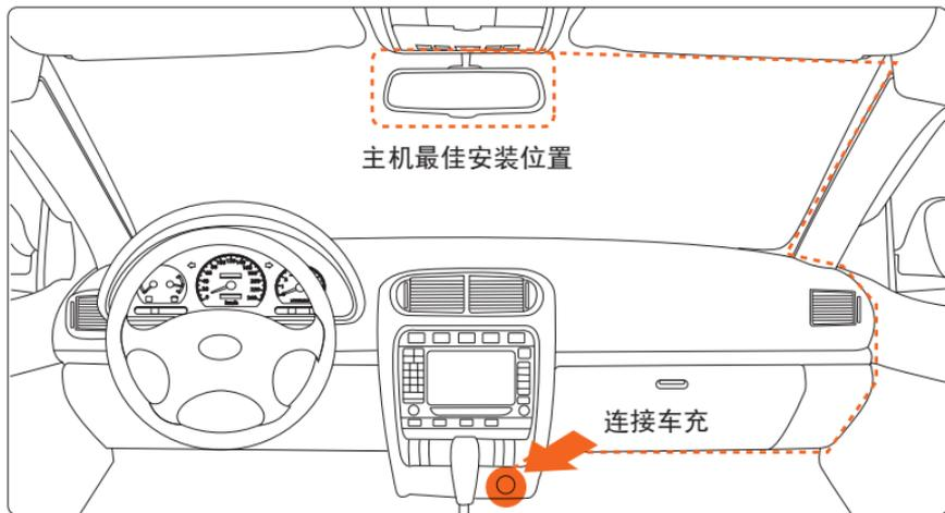
※ 切勿把机器安装在安全气囊弹盖上或安全气囊的工作范围内。本公司对因车辆碰撞或汽车安全气囊的问题而导致的伤害或死亡不承担任何责任。
