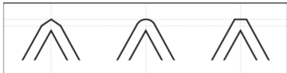
陷印连接示例，从左至右为：斜角连接、圆角连接、斜面连接
