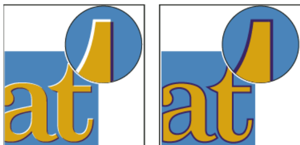
不使用陷印的套不准问题（左）与使用陷印的套不准问题（右）
